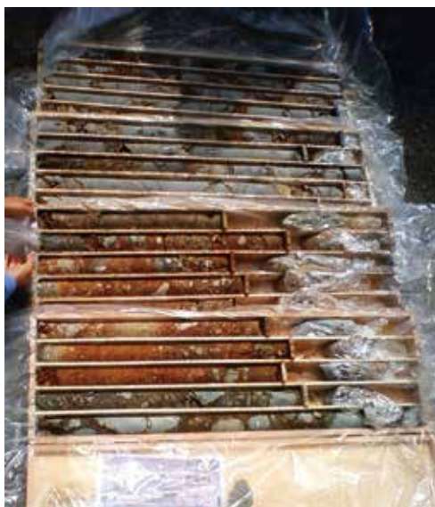
写真1 ケースに収められたボーリングコア 採取されたコアを1mごとに横に収納し下から 上へと岩石の変化がわかるよう並べたもの
